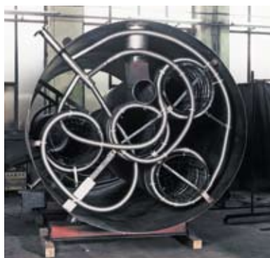
Gewellte Bauform: Maximale Wärmeübertragung/Durchströmung bis in die Randbereiche.
