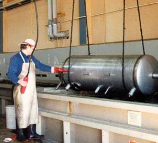
Alle FEURON-Edelstahlspeicher werden im Vollbad gebeizt und passiviert. Das sichert die Langlebigkeit.
