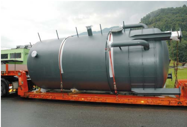
Solarspeicher: 85'000 Liter, 11,5 Meter lang und sieben Tonnen schwer.
